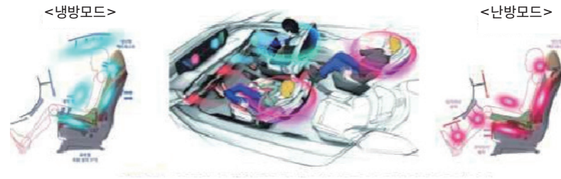
그림 6 열 쾌적성 근접 공조 복사히터·시트 개발
