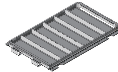
그림 1 배터리 하우징 모델링 및 시제품
